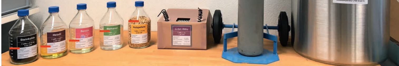
Vergleich Speicher / Energieträger: Rechts Kochtopf mit 80 Liter Wasser, das von 20 auf 100 °C erwärmt werden soll. Dafür notwendige Energie: 7 kWh. Diese ist je enthalten in den aufgereihten Energieträgern bzw. -speichern. Rote Markierungen am linken Rand der 2-Liter-Flaschen zeigen den entsprechenden Füllstand.
