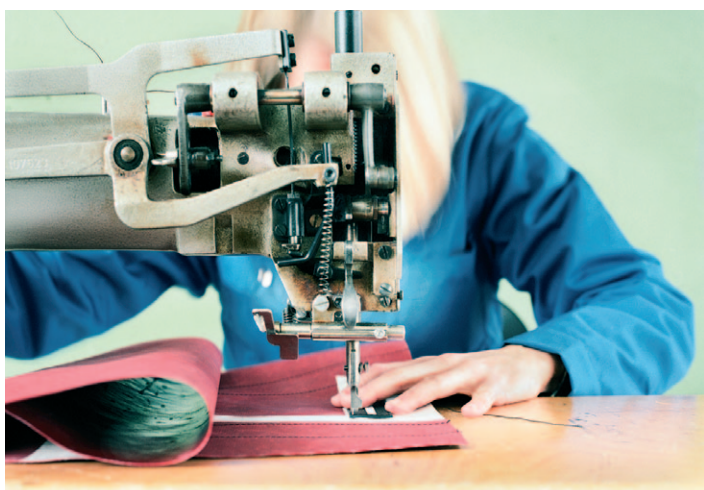
[05] Planen-Teile, Fahrradschlauch, Autogurte und Label werden vernäht
